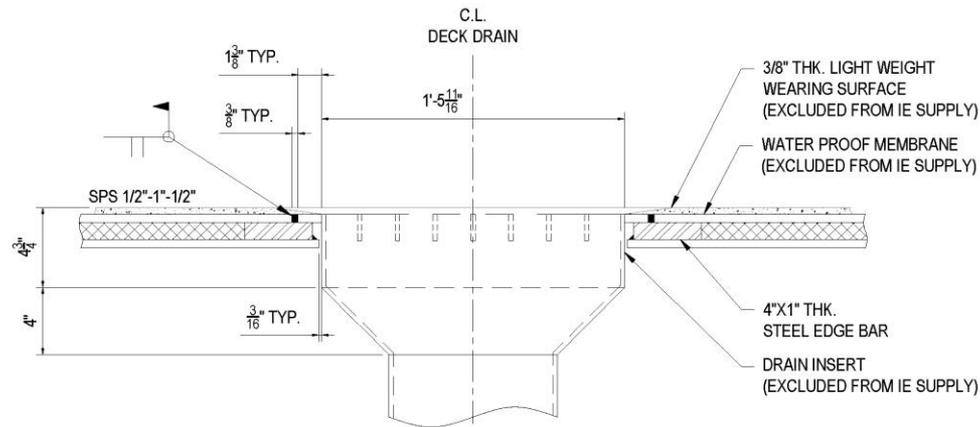
3 TYPICAL DECK DRAIN INSERT ASSEMBLY
